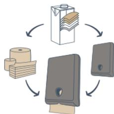
Grâce à un **procédé exclusif** et mécanique, Lucart parvient à séparer les matériaux des briques alimentaires afin de les recycler totalement. Les fibres de cellulose, dont la qualité est similaire à de la pure ouate, deviennent le **Fiberpack®**, dont sont faits les produits d'essuyage EcoNatural. L'aluminium et le polyéthylène deviennent l'**Al.Pe.®**, utilisé pour fabriquer les appareils EcoNatural Flow.
